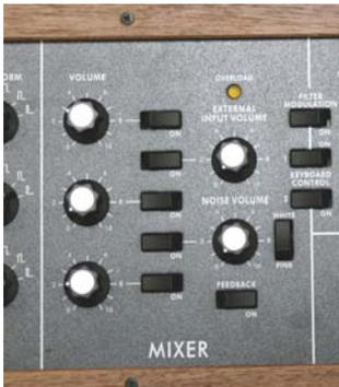
*In dieser Sektion werden die Signale gemischt, bevor sie in das Filter geschickt werden. Als Signale stehen die Oszillatoren 1 bis 3, der Noise Generator und ein Externes Signal zur Verfügung. Insgesamt also bis zu 6 Soundquellen einschliesslich Filteroszillation, welche direkt am Filter erzeugt wird. Jede Soundquelle verfügt über ein Poti zum Regeln der Lautstärke und über einen Schalter zum*
