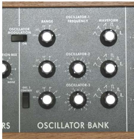
Oszillator verhält sich dann wie ein LFO, dessen Geschwindigkeit über Range und Frequency eingestellt wird. Über einen Schalter kann die Tonhöhen-Modulation der Oszillator-Sektion aktiviert werden.
