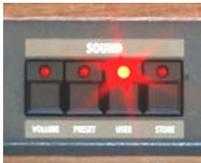
Betätigen Sie den Taster VOLUME, um die Lautstärke mit den DOWN/UP-Tastern oder dem Datenrad einzustellen. Diese Lautstärke ist nicht in einem Preset gespeichert, sondern es ist die Lautstärke des Gerätes.
