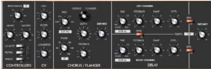
Die **Controllers Sektion** beinhaltet Bedienelemente zum Einstellen von Modulation und Pitch Band.
