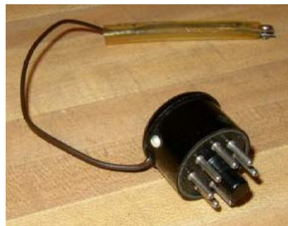
Embase intermédiaire permettant de récupérer le signal B+ de l'orgue
