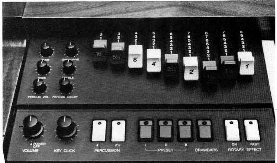
Le tableau de commande : des tirettes harmoniques, des potentiomètres rotatifs et des touches douces au toucher. Une manipulation très simple.
